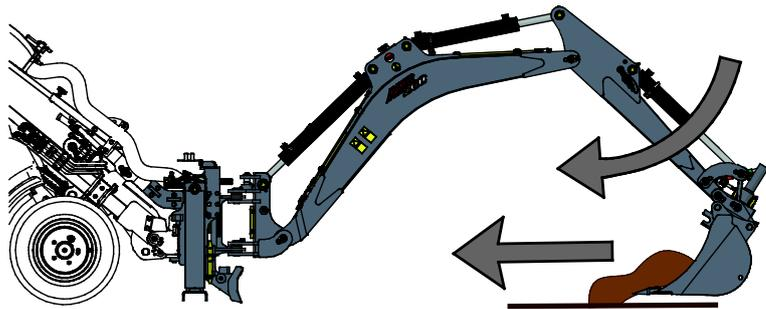
3. ■ Wenn die Schaufel ausreichend voll ist, schließen Sie sie und heben Sie den Baggerhubarm an.
