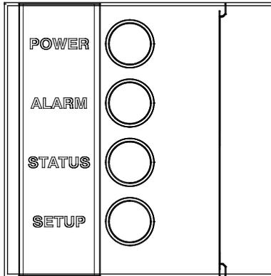
**POWER** Die POWER-LED zeigt den Status der Empfangseinheit und der Funkverbindung an.
